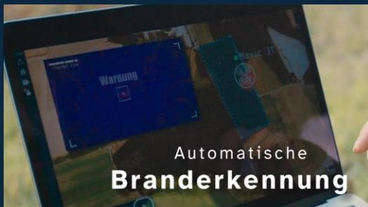
Sofern eine Feuerstelle erkannt wurde, erstellt ein intelligenter Algorithmus im Hintergrund eine Brandvorhersage, welches die Ausbreitungsrichtung des Brandes bei nicht einschreiten vorhersagt.
